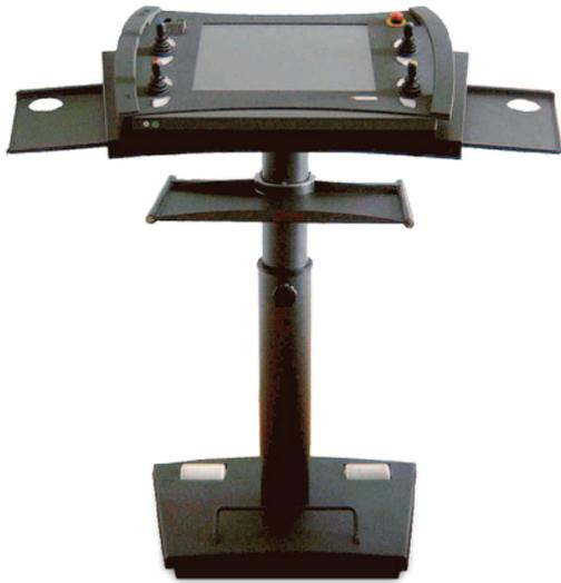
Dank der Rollen kann der Ständer an jede gewünschte Position verfahren werden. Auf jeder Seite ist eine ausziehbare DIN-A4 Ablagefläche als Konzepthalter vorgesehen. Unter dem Pult kann eine weitere Ablage ausgezogen werden, auf der bei Bedarf eine Tastatur und eine Maus Platz finden.
