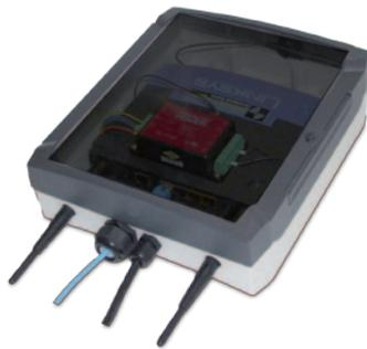
Die Reichweite der Funkverbindung hängt von den Gegebenheiten einer jeden einzelnen Bühne ab. Die verwendeten Funktechnologien garantieren im Indoor-Bereich eine Reichweite von 100 m. Sollte dies dennoch nicht ausreichen, ist auch Roaming möglich: Dann werden mehrere BRIDGE110 im Bereich der Bühne montiert. Wenn das Signal von einer BRIDGE110 zum CAT120R zu schwach wird, wird automatisch auf eine andere BRIDGE110 mit besserem Signal umgeschaltet.
