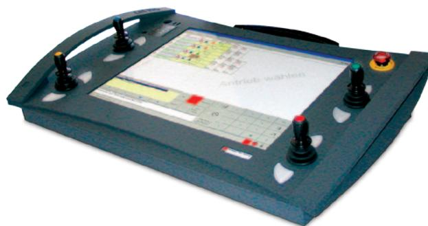
Das CAT190 kommt ohne interne Festplatten aus. Das Gerät startet mit Hilfe eines integrierten Flash-Speichers. Dieser Speicher ist schreibgeschützt und somit unanfällig gegen Viren und Spannungsausfälle. Das CAT190 kann ohne vorheriges Herunterfahren („Shutdown“) ausgeschaltet werden und dennoch treten keine Datenverluste auf.
